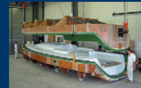
Démoulage du pont
