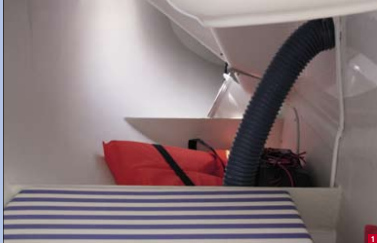
▲ La parte de popa está vacía, permitiéndonos la estiba. Además, gracias a unos separadores, evitaremos en parte el desplazamiento de los elementos estibados durante la navegación.
