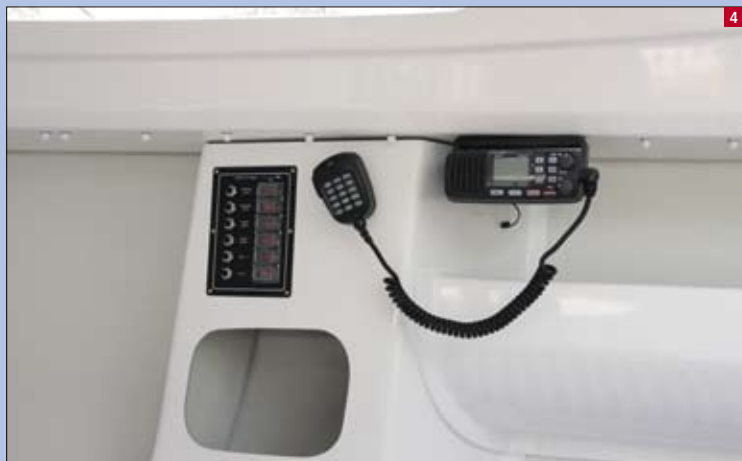
En el centro del barco encontramos un pequeño cuadro eléctrico y, junto a él, hallamos la VHF instalada. ▼
